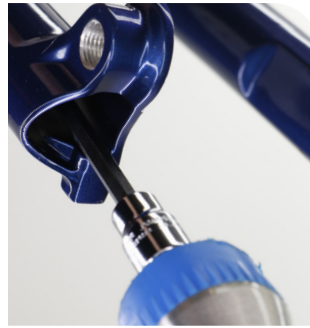
Federseite: 5 mm und Hammer
