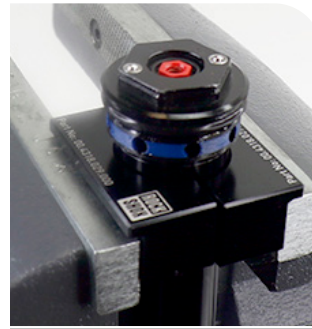
Schraubstock mit Charger-Schraubstockblöcken
