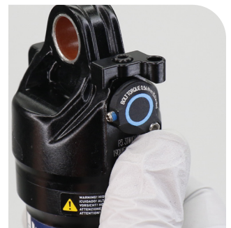
Umlenkrolle der Fernbedienung ~120°
