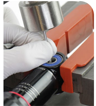
Lagerausschlagwerkzeug/Stiftlehre – 3 mm (AD)
