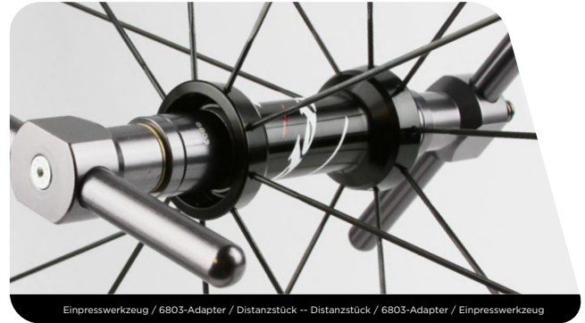
Einpresswerkzeug / 6803-Adapter / Distanzstück -- Distanzstück / 6803-Adapter / Einpresswerkzeug
