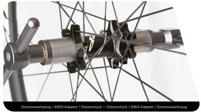
Einpresswerkzeug / 6903-Adapter / Distanzstück -- Distanzstück / 6903-Adapter / Einpresswerkzeug
