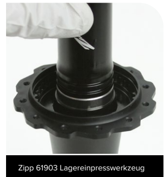
SRAM 6903 oder Zipp 61903 Lagereinpresswerkzeug
