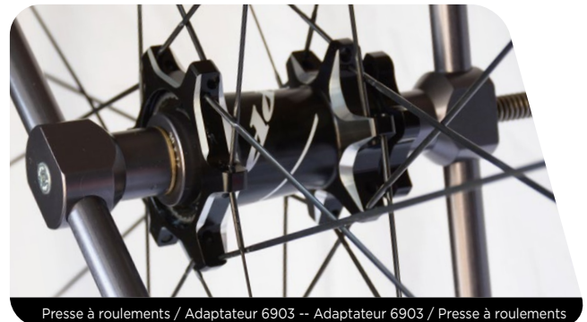
Presse à roulements / Adaptateur 6903 -- Adaptateur 6903 / Presse à roulements
