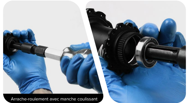
Arrache-roulement avec manche coulissant
